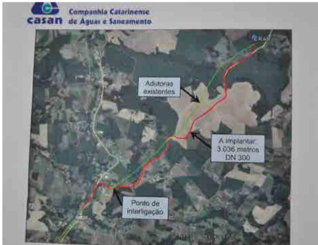
Imagem mostra novo trajeto de três quilômetros até acoplar em adutora já existente
