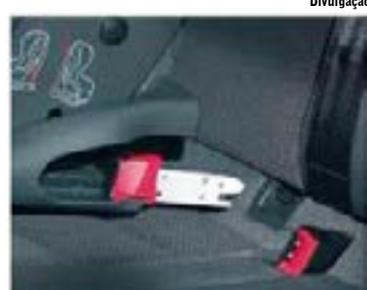
Exemplos que detalha o sistema Isofix na região de encaixe do engate metálico ao respectivo terminal de ancoragem do veículo
