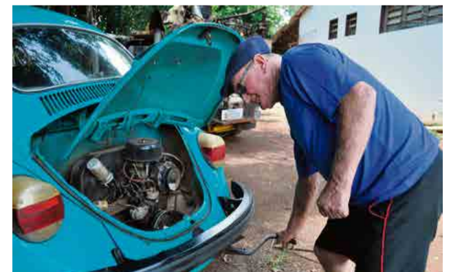
Arlindo mostra a forma de ligar o motor com uso de manivela
