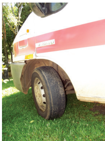
Ambulância transitava com os pneus em péssimas condições
