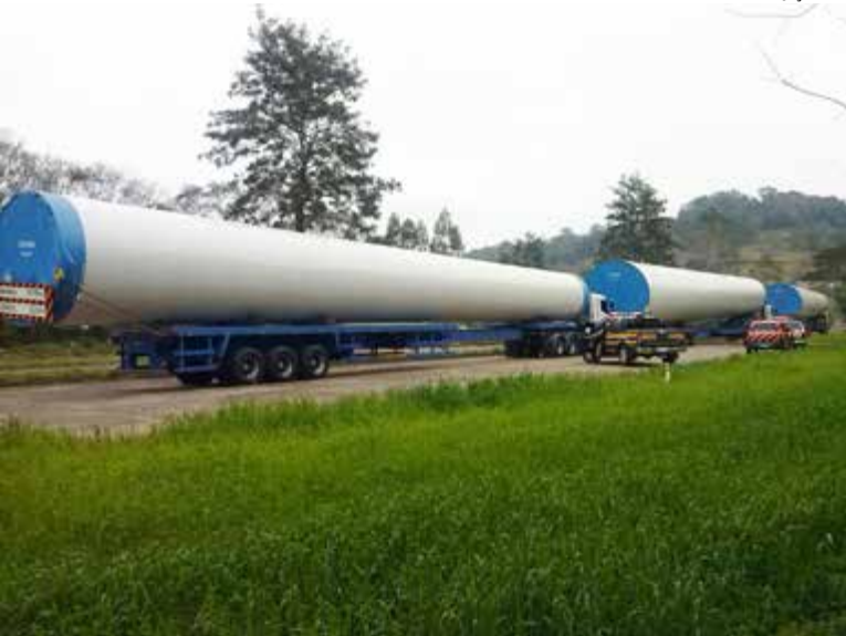
Veículos transportavam peças de usinas eólicas com mais de 30 metros de comprimento e mais de quatro metros de largura cada peça
