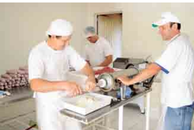
Carne do salame é embutida na tripa com auxílio da máquina
